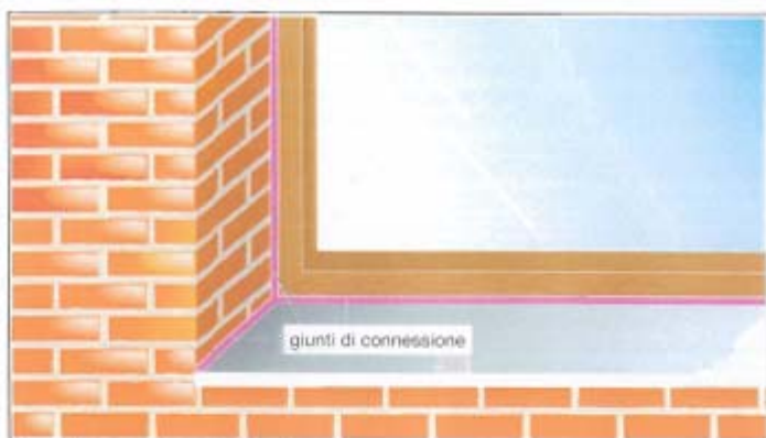
Giunti di connessione finestra/muro
