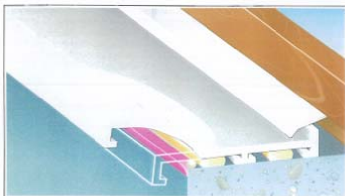
Sigillatura ed incollaggio di davanzali in alluminio
